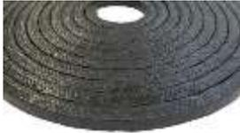
**VG2** - Пряжа из волокон полиакрилового нитрила (PAN) и чистого хлопка. Самосмазывающееся волокно PAN улучшено за счет тщательной пропитки графитовой смазкой, которая практически исключает царапины и износ вала.
